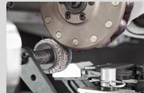
**Dispositivo per raschiatura e pulitura anelli ribattitori.** Mantiene l'efficienza dell'utensile durante l'uso.
