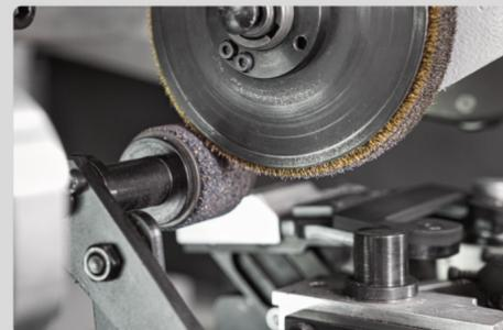
**Affilatura ideale con il diamantatore spazzola.** Mantiene l'efficienza della spazzola al massimo delle prestazioni durante l'uso.
